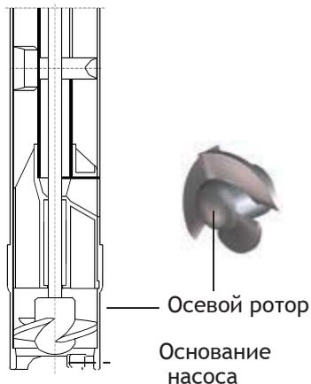
F/FP 427 с корпусом подшипника и осевым ротором
